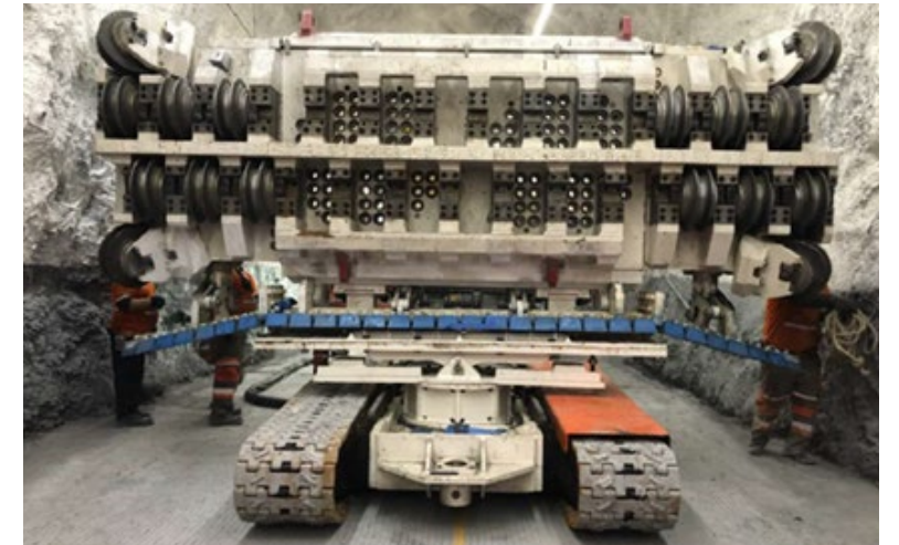
▲ Figura 7. Cabezal de corte MDM sobre un transportador de orugas.
