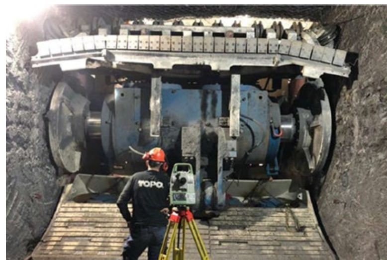
▲ Figura 6. Vista frontal de la MDM mostrando el delantal de recolección.
